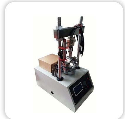
Tester automatico di stabilità Marshall
